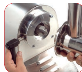
Modelo PI-32 con boca fácilmente desmontable para su limpieza.
