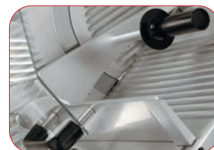
Protecciones de seguridad.
